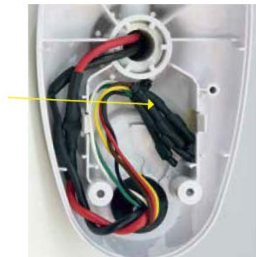
Imagen 17 Colocar los cables aislados del AutoPilot en la parte inferior central de la caja de control tal y como se muestra en la imagen
