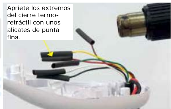
Imagen 16 Aislar y sellar los 6 cables del AutoPilot en los motores Riptide SP con los termo-retráctiles suministrados.
