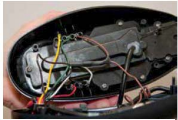
Imagen 14 Insertar los cables del AutoPilot en los porta-terminales
